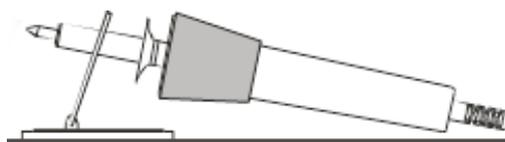
**Changement des embouts :** employez toujours un outil, afin de ne pas vous brûler les doigts. Déposez l'embout chaud sur une assiette en pyrex ou autre matériel résistant à la chaleur pour le laisser refroidir.
